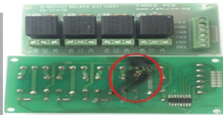
(d) Control kit (relay kit) failure
