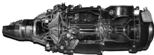
*Fig. 1 TS-20B/21 turbo starter*
